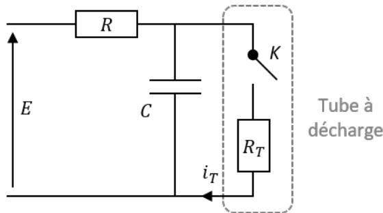
Une tension  $E$  constante de quelques centaines de volts est utilisée pour charger un condensateur de capacité  $C$ .
